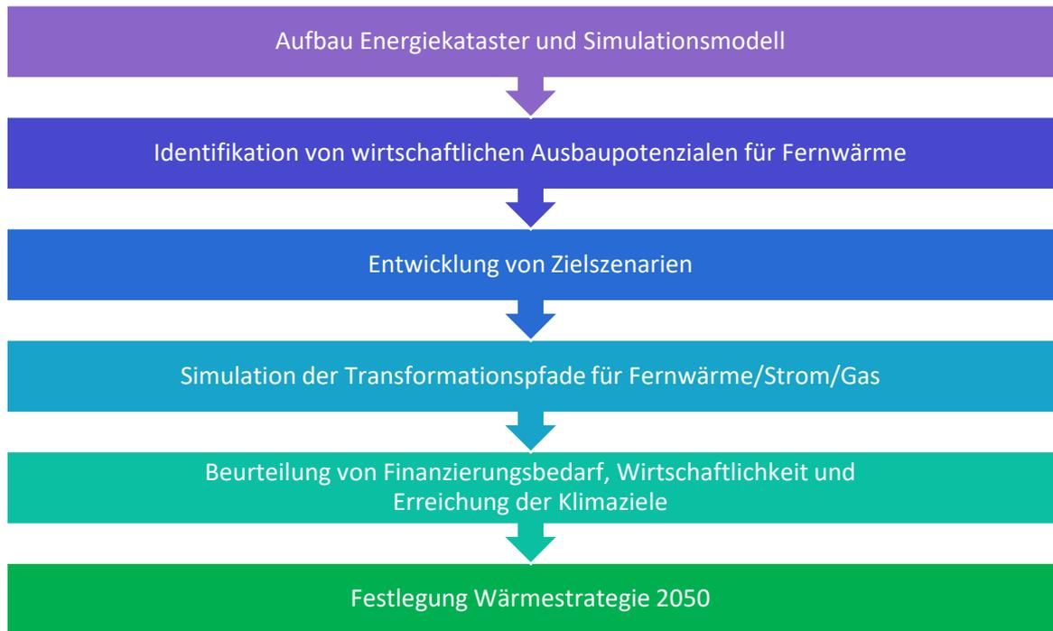
Abbildung 2-3: Schematische Darstellung der Vorgehensweise der integrierten Energieplanung und Simulation
