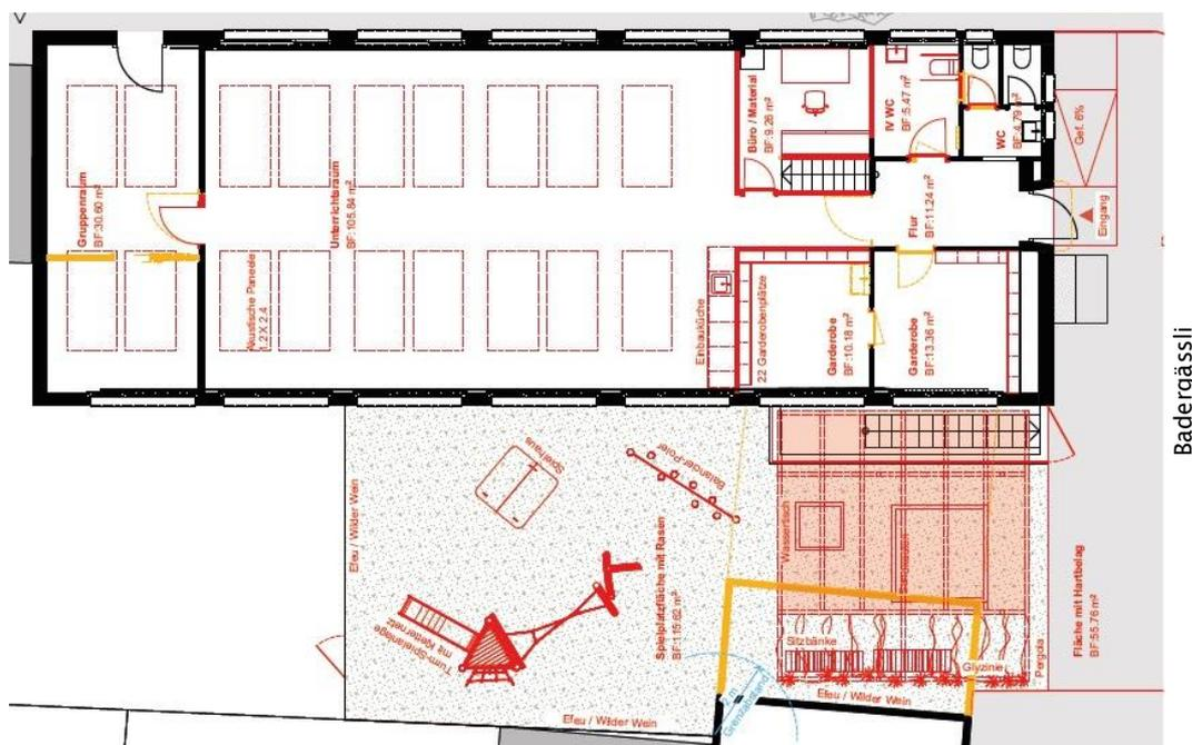
Abb. 4 Grundriss Badergässli 6, favorisierte Layoutvariante mit abgetrenntem Gruppenraum und Lehrerarbeitsplatz (ohne Massstab; gelb = Abbrüche, rot = neu)
