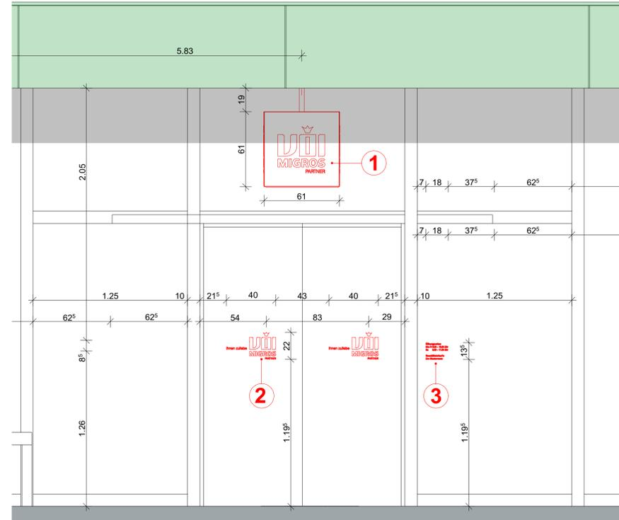
Fassadenanschnitt Detail für Positionierung Reklame Pos. 1,2,3,4 M1:20
