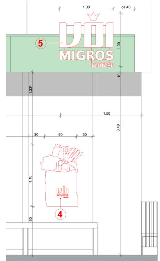
Fassadenanschnitt Detail für Positionierung Reklame Pos. 4,5 M1:20
